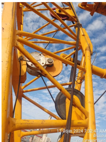
ภาพที่ 5-27 ตรวจสอบอุปกรณ์ปั้นจั่น ให้มีความสมบูรณ์ก่อนเริ่มการทำงาน
